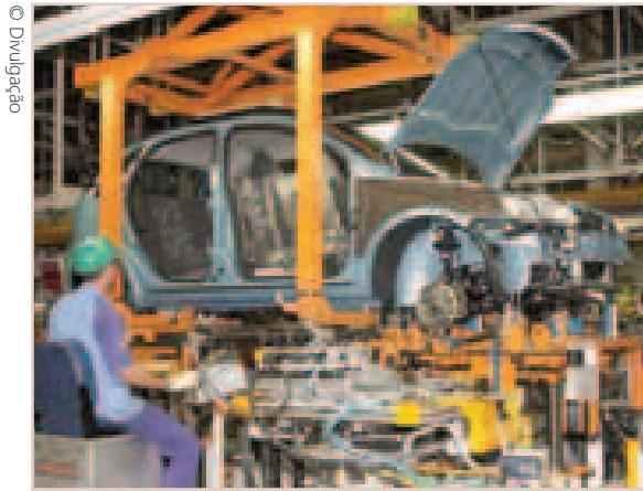
Fig. 71. A linha de produção automatizada do carro Chevrolet Corsa.
